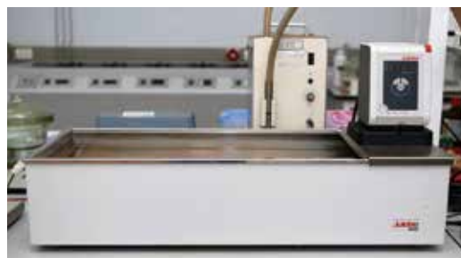
Hình 7. Bể ổn nhiệt Julabo Corio CD-B33
