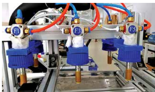
Hình 25. Paraffin của dầu thô mỏ Cá Ngừ Vàng bám dính lên các cold finger sau thử nghiệm
