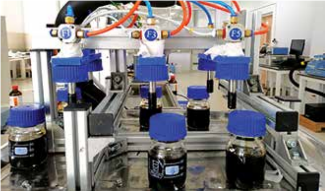
Hình 22. Paraffin của dầu thô Rạng Đông bám dính lên các cold finger sau thử nghiệm
