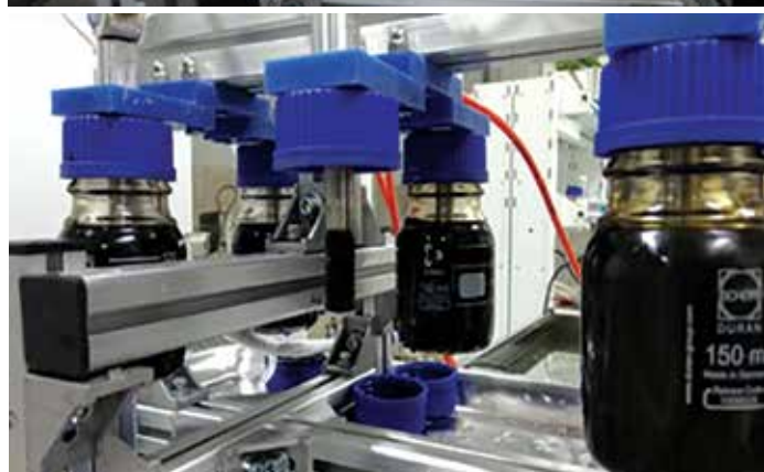
Hình 13. Hệ giá đỡ 6 cold finger
